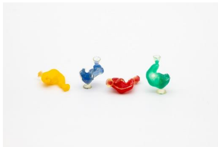
Gussformen für die Herstellung von Hörgeräten, gefüllt mit einem eingefärbten Silikon
