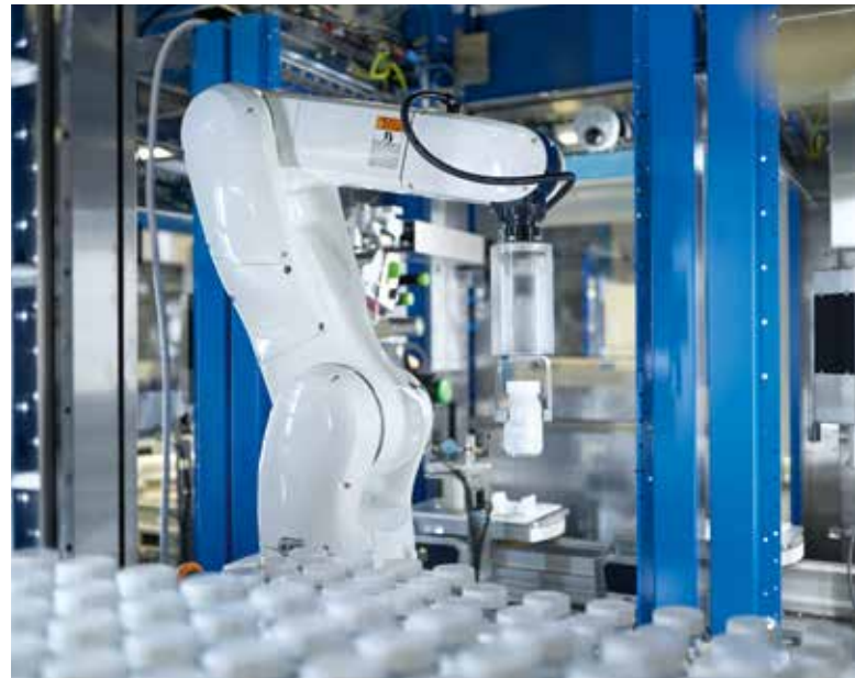
Es gibt 32 Module mit 27 unterschiedlichen Funktionalitäten, um Additive in Lacken, Kunststoffen und Klebstoffen abzu prüfen.
