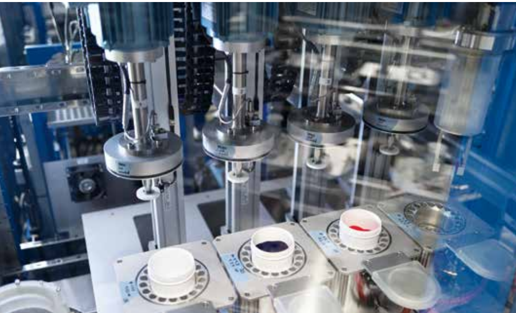
Mit der vollautomatischen Anlage bei BYK in Wesel können 220 Proben in 24 Stunden im Hochdurchsatz hergestellt und geprüft werden.
